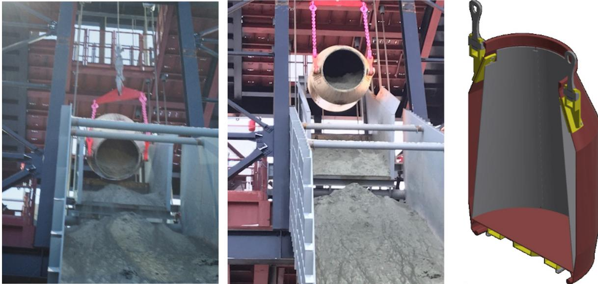
**Abbildung 9: Entleerung der Bergeskübel**
