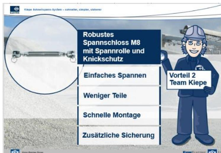
Die Lösung war sehr einfach. Das alte Spannschloss Öse-Öse, Kettennotglied und Kausche wurden ersetzt durch nur eine Komponente: das Schnellspannschloss. Das Edelstahlspannschloss hat leicht zu öffnende Gabeln, eine eingebaute Spannrolle sowie einen Verdrehschutz. Die Spannrolle hat den Durchmesser einer Kausche und unterstützt beim Spannen der stumpfen Reißleine mit Ummantelung deutlich.
