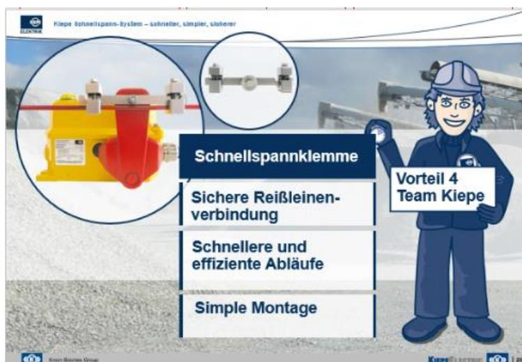
Dazu benötigt man eine sichere, aber flexible Befestigung zwischen Reißleine und Seilzug-Notschalter: die Schnellspannklemme. Gemäß Norm muss das Stellteil eines Seilzugnotschalters einer 5-fachen Zugkraft widerstehen. Hier besteht Interpretations-Spielraum, weil die kleine Betätigungskraft des Schalters herangezogen werden könnte. Kiepe macht hier keine Kompromisse. Die Klemme ist auf 5x 125 N (max. Betätigungskraft an der Reißleine nach EN 620) ausgelegt.
