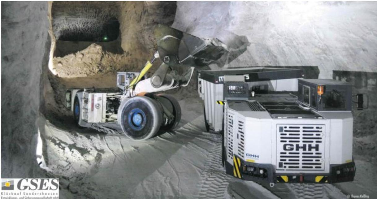
**Abbildung 3: MK-A35 in EU Stage V im Einsatz bei der GSES mbH
