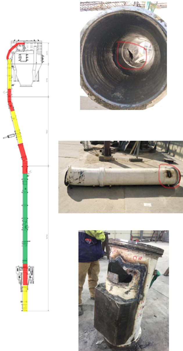
**Abbildung 8: Starker Verschleiß an der Saugleitung**
