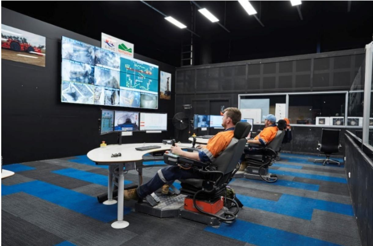
**Abbildung 2: CMOC Grubenwarte für Laderautomatisierung [1]**
