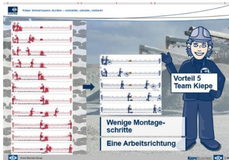
Dass sich die Laufwege verkürzen, kann man in dieser Übersicht erkennen, die grob den Ablauf der Montageschritte in einer herkömmlichen und in einer durchgängigen Installation mit Schnellspannklemme skizziert.
