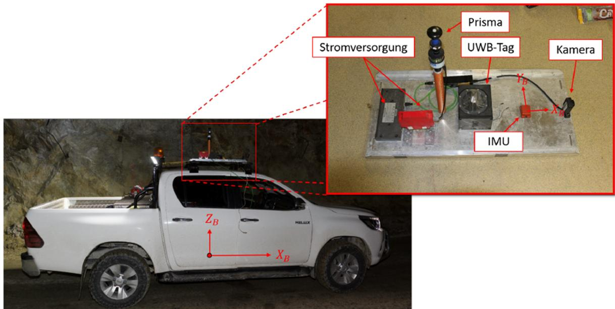
**Abbildung 1: Sensorsystem auf untertägigem Fahrzeug bestehend aus UWB-Tag, Inertialer Messeinheit (IMU) sowie Referenzsystem (Kamera, Prisma)**
