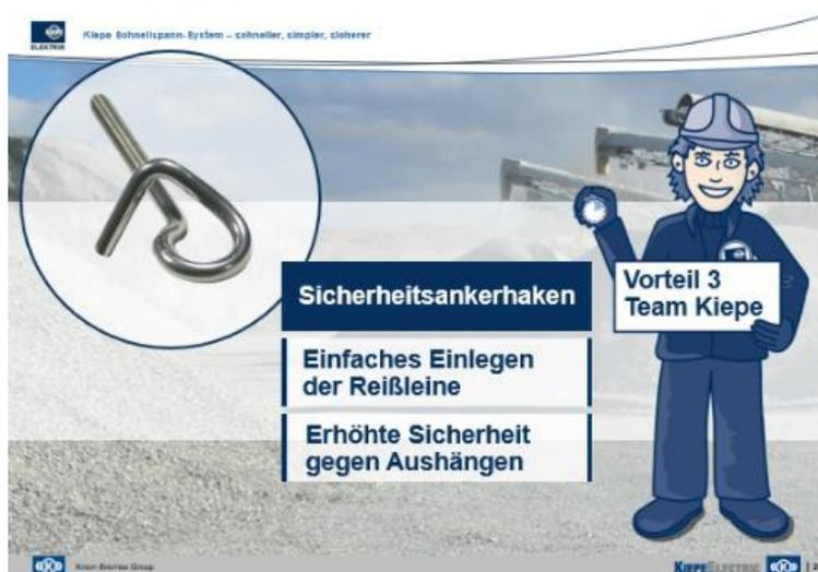
Der Sicherheitsankerhaken besitzt ein um 90° gewinkeltes Ende. Somit kann die ungespannte Reißleine mit einer geschickten Bewegung eingehängt werden. Ein Einfädeln ist nicht mehr erforderlich. Der Winkel hat zudem den Vorteil, dass sich die Reißleine im Betrieb und bei der Betätigung nicht aushängen kann, weil dabei zwei Betätigungsrichtungen gleichzeitig erforderlich sind. Dies erhöht die Sicherheit gegen Aushängen.
