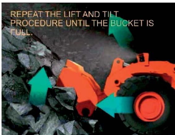
**Abbildung 7: Hub-, Kipp- und Eindringsequenz beim Beladevorgang [3]**
