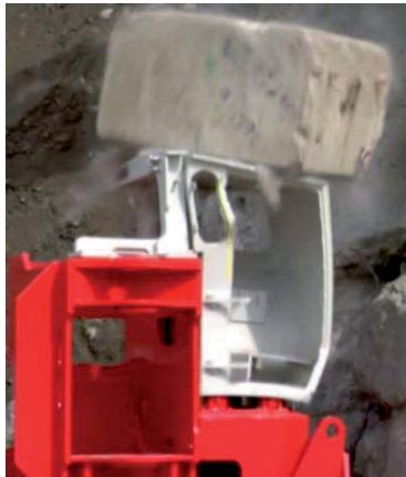
**Abbildung 10: Aufprall eines 5 t Gewichts aus 6 m Höhe auf Sandvik Kabine**
