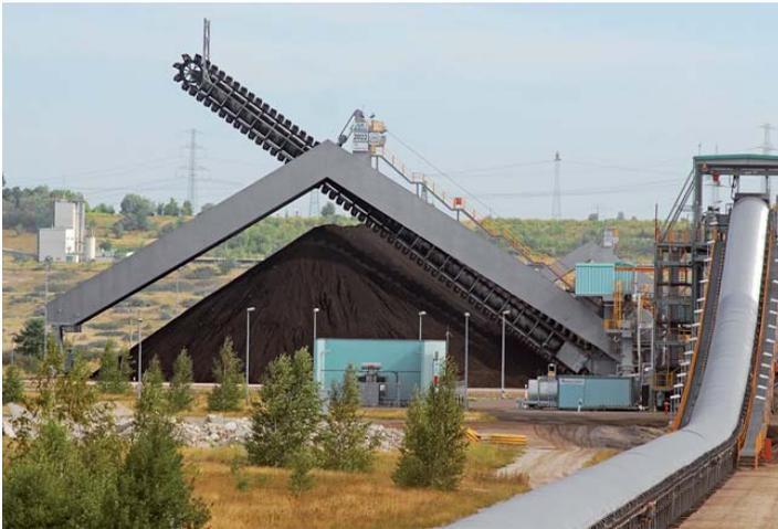
**Abbildung 11: Portal-Kratzer mit einseitigem Kratzerausleger der Firma TAKRAF (MIBRAG Mitteldeutsche Braunkohlengesellschaft mbH, Schleenhain), Quelle: TAKRAF.**
