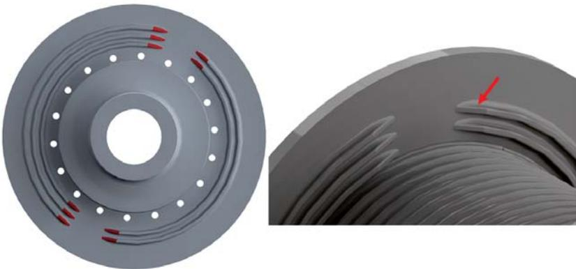
**Abbildung 14: Exemplarische Darstellung notwendiger Übergangsgeometrien zwischen Parallel und Kreuzungsbereich**
