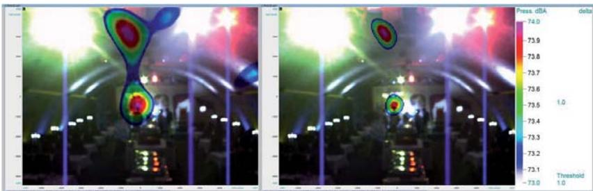
**Abbildung 4: Lärmausbreitung in einem untertägigen Gewölbe, Hauptschallquelle und Reflektionen, Darstellung mit unterschiedlicher Filterung**
