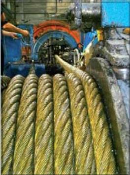
Komplexes Einlagen-Design sichert die Lastverteilung und die optimale Abstützung der Seilaußenlitzen
