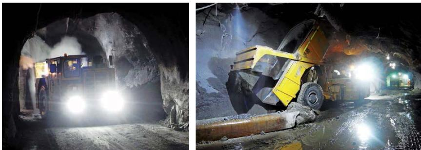
**Abbildung 12: Beladung durch 6-7 yd<sup>3</sup> Fahrlader sowie Entladung in höher gelegene Aufgabestationen**
