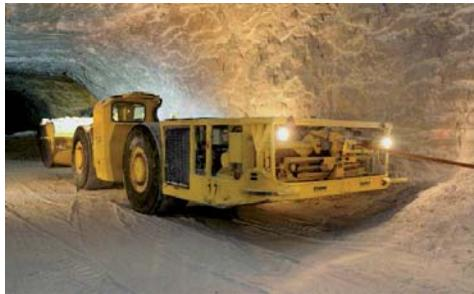
**Abbildung 7: LHD Lader elektrisch betrieben, Bild: GHH Fahrzeuge**
