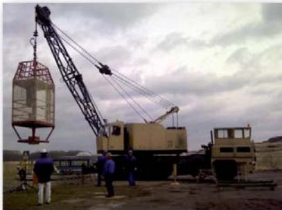
Zugang zur Grube Siegfried-Giesen mit einer Autoschachtwinde
