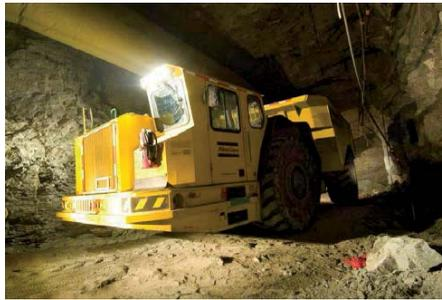
**Abbildung 8: Minetruck 60 Ton, Bild: Atlas Copco**
