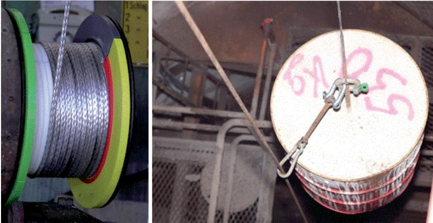
**Abbildung 18: Seiltrommel mit faserseilspezifischen Anpassungen und Testgewicht im Schacht**
