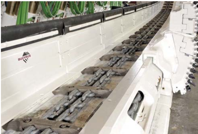
Abbildung 10: Strebförderer PF 4/1132 mit angeschweißter Hobelführung GH 1600 und geöffneter Inspektionsklappe
