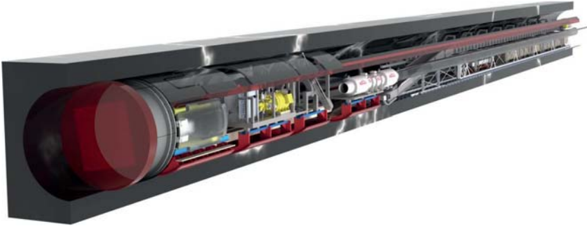
Abbildung 3: Mico-Tunnelbohrmaschine mit Ketten-Übergabeförderer für eine Sohlflurbahn zur Haufwerksabförderung
