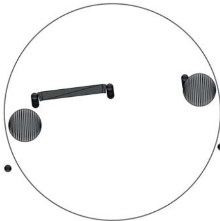
Abbildung 4: Verformung eines endlosen ringförmigen Gurtes in seinen Einbauzustand durch Zusammenbau der Anlage eines beispielhaften Gurtförderers
