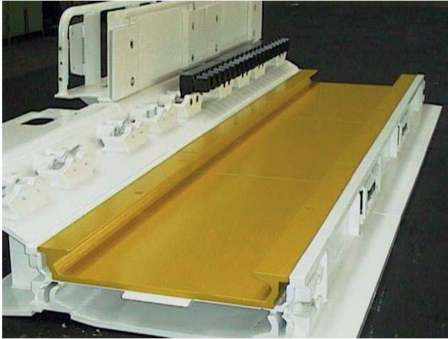
Abbildung 6: Förderrinne (hier PF 2.4) für einen Walzenstreb mit Wechseltrog (gelb)
