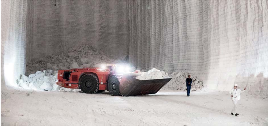
Abbildung 4: Sandvik LH621 im Strossenabbau, Bergwerk Bernburg [1]
