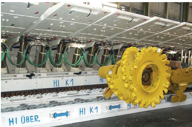
Abbildung 7: Walzenlader mit Rollenkufer auf einem Strebförderer mit L-Fahrbahn
