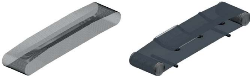
Abbildung 6: In der DEM-Umgebung generierter Gurt in Darstellung der Partikelverbindungen (li.) und mit halbtransparenten Gurtpartikeln (r.)
