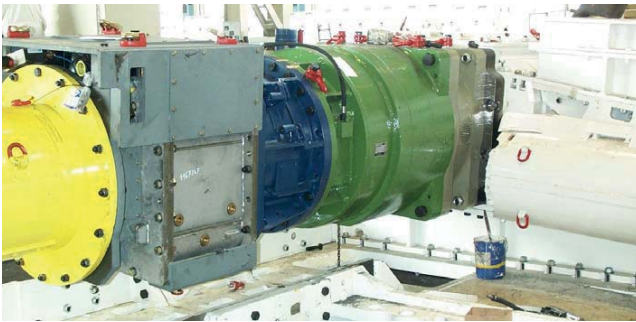
Abbildung 18: DTP-Kupplung mit einem starren Getriebe und 800 kW Antriebsleistung [Fa. Voith]
