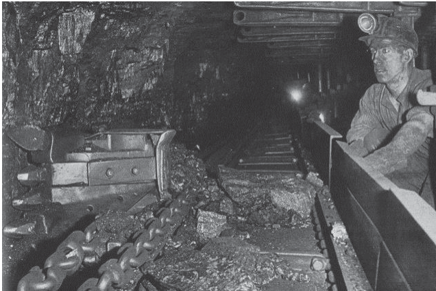
Abbildung 2: Panzerförderer PF I mit Doppelaußenkettenband und mit Löbbe-Hobelanlage (links im Bild ist die offen laufende Hobelkette zu sehen).
