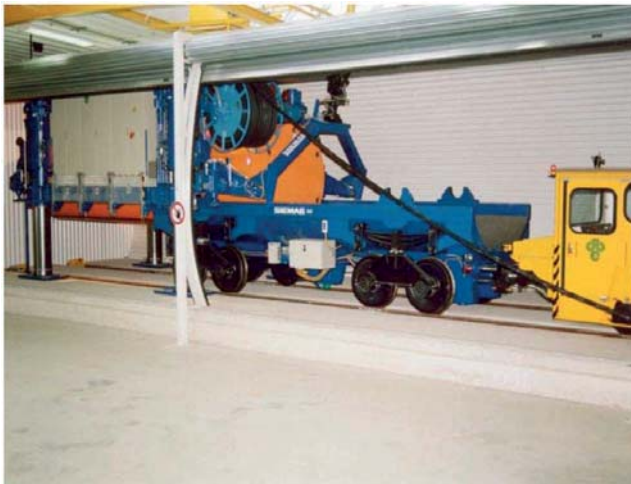
Abbildung 1: Versuchsstand zur Demonstration der Streckenlagerung von POLLUX-Behältern [Filbert, 1995]
