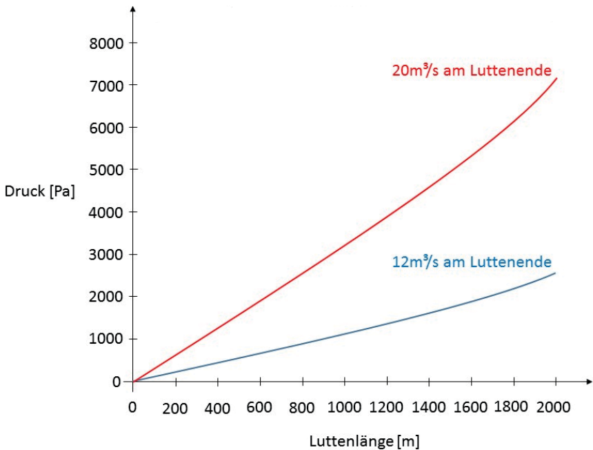
Abbildung 1: Beispielhafte Betrachtung von Druckverhaltnissen in A-Lutte mit \varnothing 1,2 m
