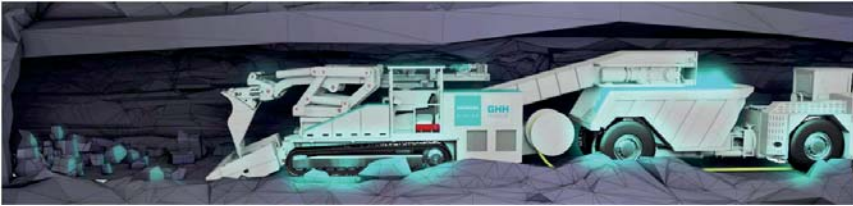
Abbildung 1: Roadheading Excavator mit Muldenkipper zur Materialförderung
