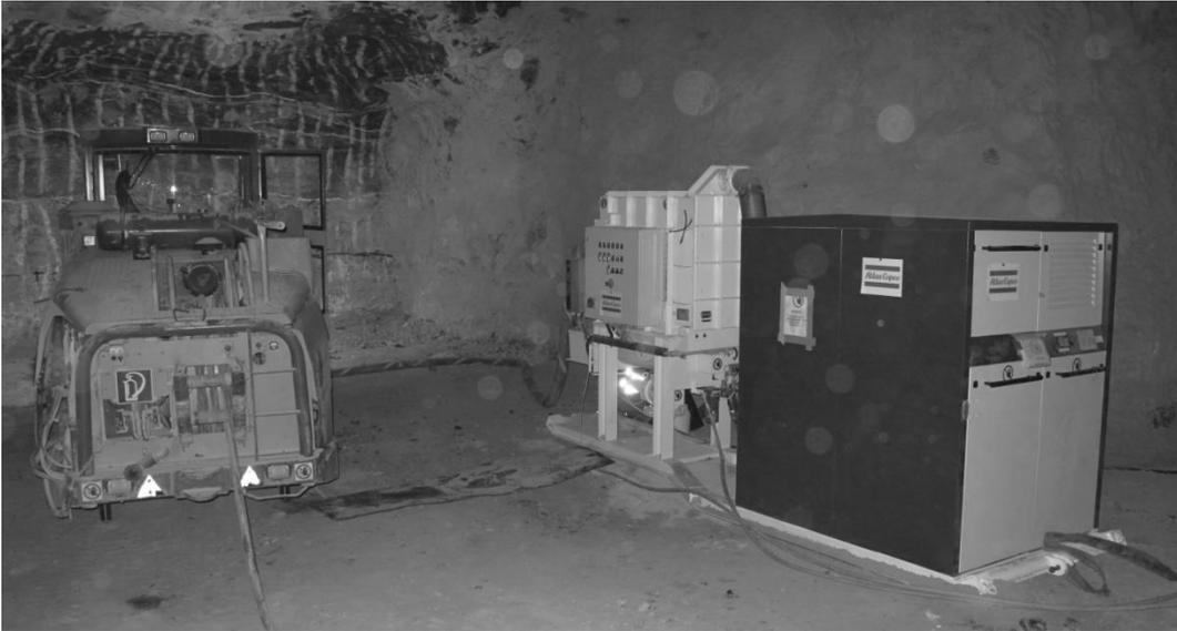
Abbildung 5: Atlas-Copco Boomer mit CFT-Absauganlage
