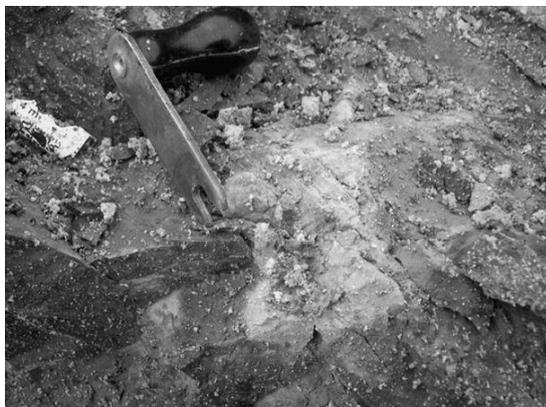
Abbildung 14: Mit Hohlladung (Cu-Liner) abgeschossene Spitze eines Grauwackesteins
