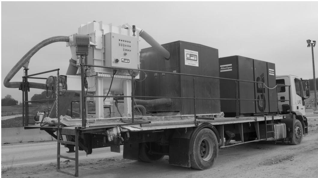
Abbildung 7: Atlas Copco Kompressor mit CFT Absauganlage
