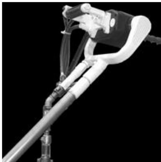
Abbildung 6: Druckluftdrehbohrmaschine mit Bohrsäule
