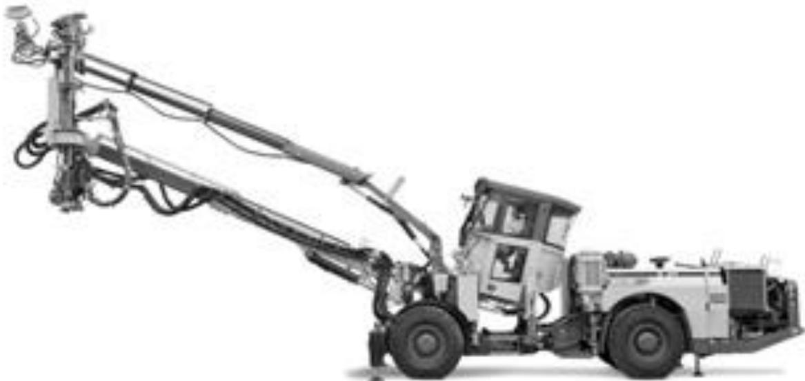
Abbildung 9: Ankerbohr- und Setzgerät mit Mattenhalter Typ Boltec EC
