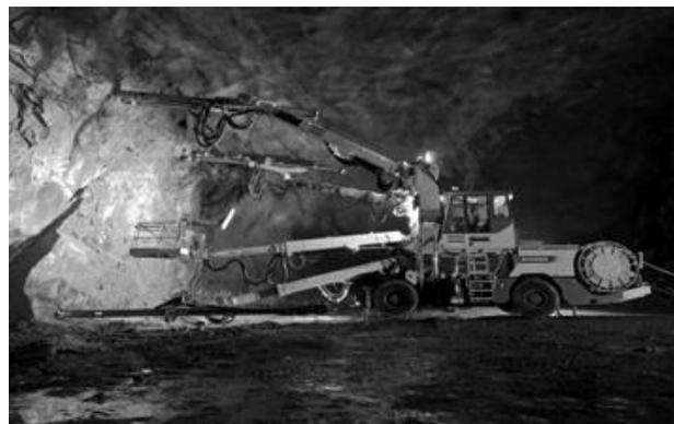
Abbildung 8: Bohrwagen mit 4 Bohrarmen und Ladekorb
