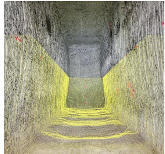
Abbildung 4: Positionierung des Halbdamms in der Versuchsstrecke (links) / Blick in Richtung Ortsbrust überlagert mit Dreiecksvermaschung (rechts)
