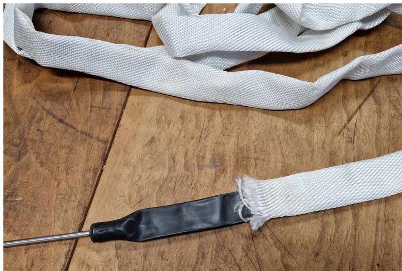
Abbildung 6: Gewebeslauch mit innenliegendem Packerschlauch
