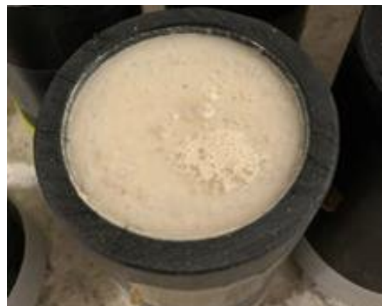
Abbildung 52: Überstandslösung auf einem Probekörper nach einem Tag.
