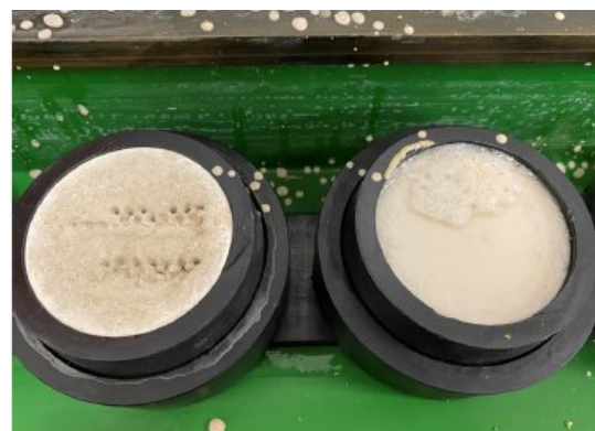
Abbildung 60: Linke Mischung: Sorelbeton mit Anhydritmehl (8% zusätzlich), rechte Mischung: Sorelbeton ohne Anhydritmehl [20]
