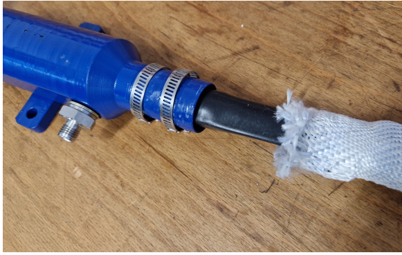
Abbildung 7: Prototyp des Anschlussstücks mit installiertem Packerschlauch (der Gewebeschlauch ist zur Ansicht zurückgezogen).
