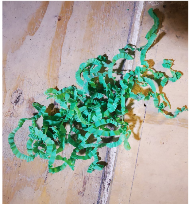
Abbildung 30: Typischer Endlosspan des Kunststoffrohres
