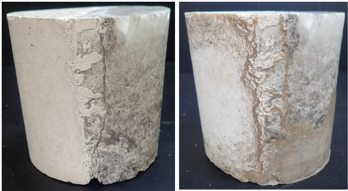
Abbildung 46: Links vor Injektion / rechts nach Injektion
