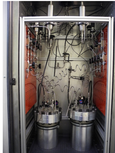
Abbildung 107: Foto Zweikammerversuchsanlage für Gas.
