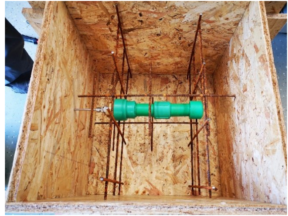
Abbildung 16: Versuchsaufbau zur Testung des Kunststoffrohres bis 2,5 MPa
