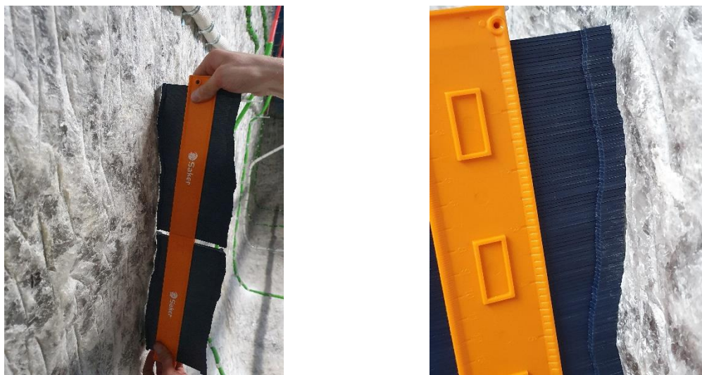
Abbildung 5: Links: Ermittlung der Rauheit am Stoß, rechts: Detailbild
