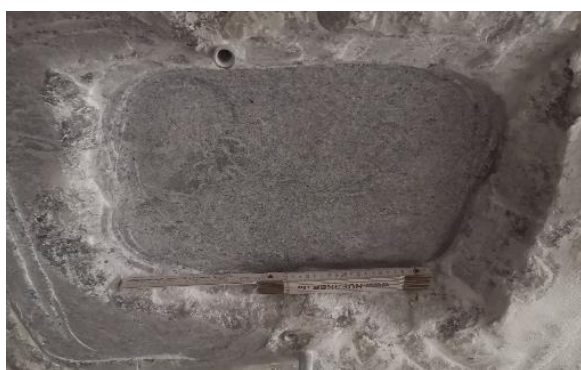
Abbildung 16: Mittels Schleifrahmen geschliffene Oberfläche
